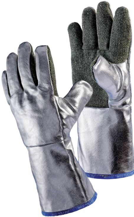
Handschuhe aus Preox-Aramidgewebe in der Handinnenfläche finden Einsatz bei Arbeiten mit Werkzeugen in Gießereien, die sich schnell aufheizen und mit denen in der Nähe von Öfen gearbeitet wird. Durch den Carbonanteil im grünen Gewebe erreichen wir eine höhere Spitzentemperaturbelastung. Neben Gießereien wird der Handschuh auch in der Glasbearbeitung eingesetzt, da das Gewebe sehr weich ist und Verfärbungen auf dem Glas nicht bekannt sind.
